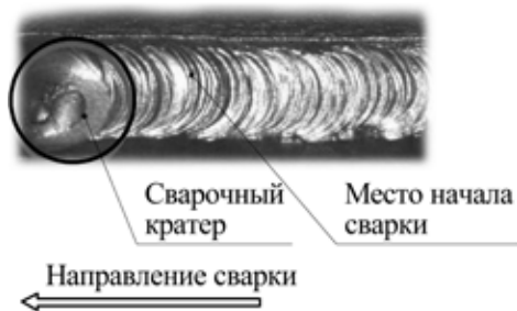
Рис. 8.4. Начало сварки при смене электрода.
